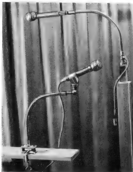
Bild 1. Mikrofon-Schwanenhäse aus flexiblem Schlauch
